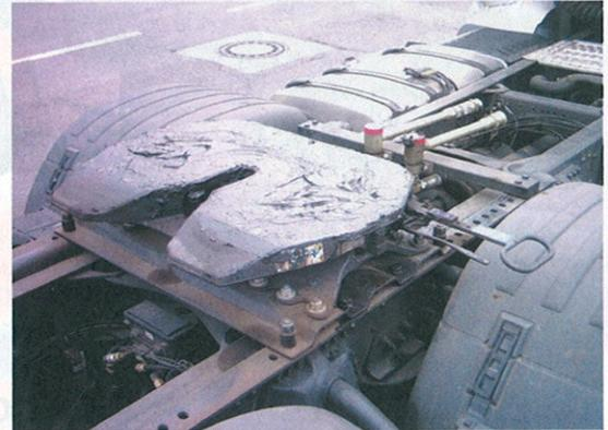
Auf dem Metallrahmen kann die RFID-Antenne montiert werden, um den RFID-Tag am Auflieger auszulesen. Der Reader wird entweder im Führerhaus oder zum Beispiel im Batteriefach geschützt untergebracht.
