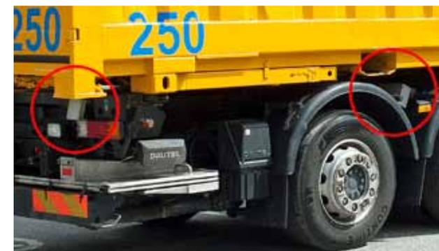
RFID-Lesegerät, -Antennen, GPS-Empfänger und GPRS-Sender befinden sich am Motorwagen, Transponder an der Wechselbrücke. Eine der Herausforderungen bestand darin, ein Reader-System zu finden, das zuverlässig über eine Reichweite von vier Metern im metallischen Umfeld funktioniert.
