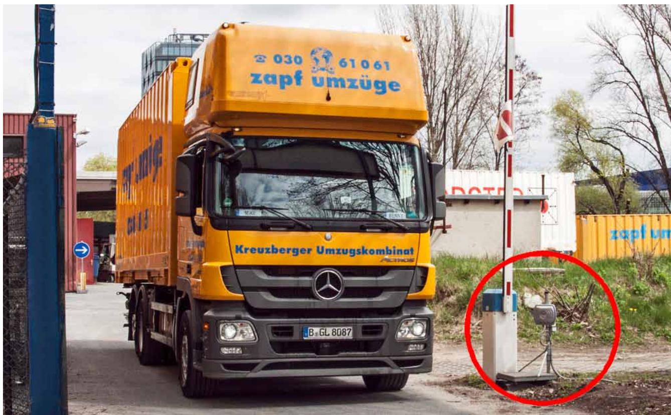
Automatische und zuverlässige Erfassung aller Lkw, Wechselbrücken, Lafetten, Hebebühnen bei der Durchfahrt des RFID-Gates und Datenübermittlung der Ein- beziehungsweise Ausfahrt an die Disposition.
