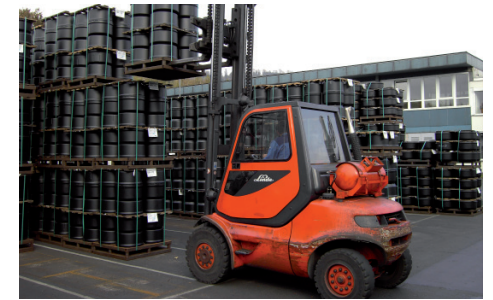
RFID-Reader am Stapler, Transponder im Boden: Transparente Warenbewegungen beim Eisengussproduzenten M. Busch
